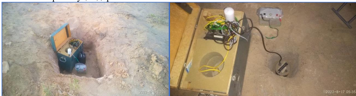
3-расм. Guralp 6TD сейсмометри ёрдамида шовқин даражасини ўрганиш жараёни.
