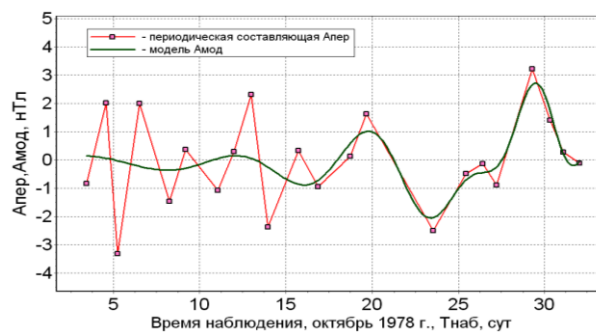
Рис. 5. Аппроксимация периодической составляющей A_{пер} короткопериодной предвестниково-аномалии магнитного поля, зафиксированной накануне Алайского землетрясения, ее моделью A_{мод} .
